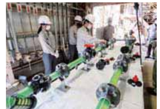
液体を移送した後の配管内の残液状態がわかるように透明配管を使った安全研修を行っております。本研修では配管の解体作業時の危険予知を高めることを目的としています。
